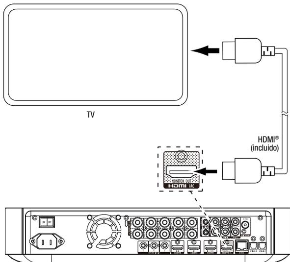
**IMPORTANTE:** Si su televisor admite el canal de retorno de audio HDMI y usted tiene acceso a canales de televisión digital por medio del sintonizador incorporado en su televisor o tiene otras fuentes ya conectadas directamente a su televisor, puede llevar el sonido al receptor BDS a través del canal de retorno de sonido del conector de salida del monitor HDMI, y no precisará conexiones adicionales al receptor.
